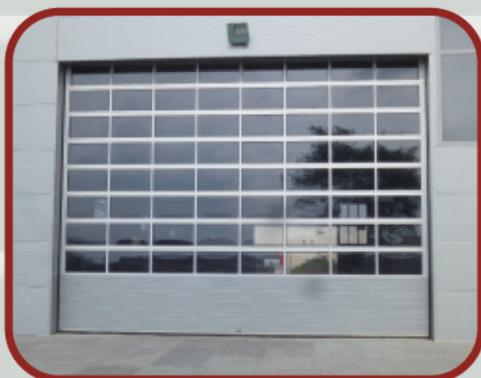
Das TTW-S-Sektionaltor ist auf isolierter Paneele aufgebaut. Beidseitig ist das Paneel aus verzinktem Stahl in Stucco-Motiv gefertigt. Der Kern der Paneele besteht aus 40 mm FCKW-freier Hartschaumfüllung. Abdichtungen rund um das Tor sorgen für Schutz gegen Regen, Wind und Verschmutzung.
